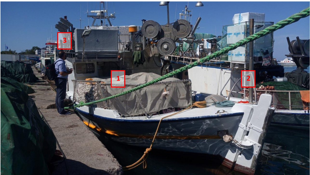
Εικόνα 2: άποψη του Α/Κ ΠΑΝΑΓΙΑ από την πρύμνη. Διακρίνονται: 1. Χώρος αποθήκευσης διχτύων, 2. Οδηγός (μεταλλική δοκός που περιορίζει τη διεύθυνση ρίψης – συλλογής των διχτύων), 3. Χώρος αποθήκευσης ρομπότ.
